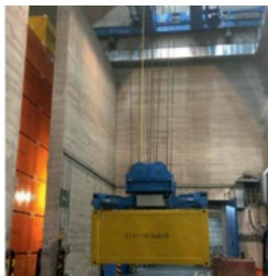
Abb. 1: KONRAD-Container am Haken – Umlagerung im Zwischenlager der KTE auf dem Campus Nord
